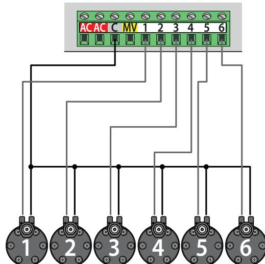
Per elettrovalvola 24V 1''F e 1''M (codice); - For 24V solenoid valve 1''F and 1''M (code); - Pour électrovanne 24V 1''F et 1''M (code); - Für Magnetventil 24V 1''IG und 1''AG (Art.); - Para electroválvula 24V 1''H y 1'' M (código);
