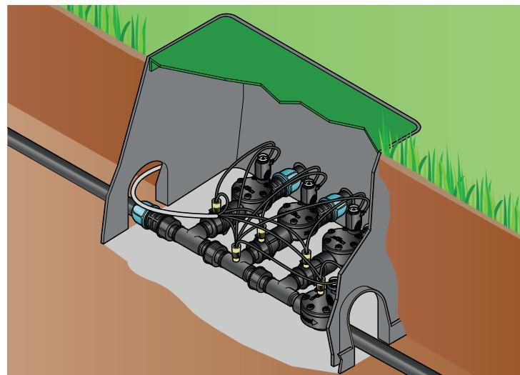
Per elettrovalvola 24V 1" F e 1" M (codice); - For 24V solnoid valve 1" F and 1" M (code); - Pour électrovanne 24V 1" F et 1" M (code); - Für Magnetventil 24V 1"IG und 1" AG (Art.); - Para electroválvula 24V 1"H y 1" M (código):
